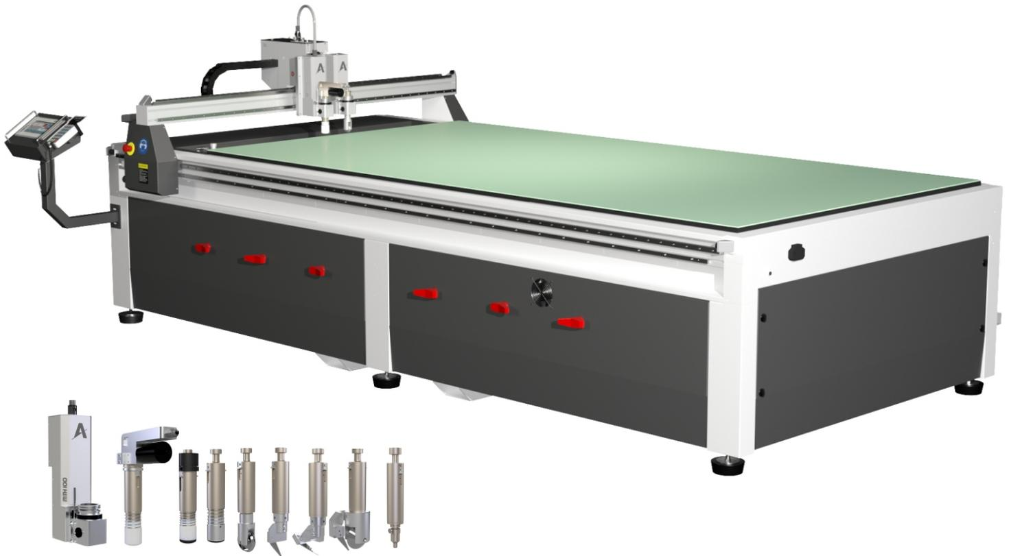
Plotter de corte y hendido de formato medio, para producciones donde se requiera rapidez de prototipado, preseries y pequeñas tiradas con altas precisiones de trabajo en diferentes materiales, como todo tipo de cartones, espumas, aislamientos, etc.. Muy robusta y con bajo mantenimiento, características de toda la serie PLC. Configurable con diferentes sistemas de cabezales y herramientas tangenciales, incluso con cámara para lecturas de marcas. Área útil de trabajo de 150x150cm y altura de 100mm
