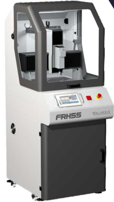
Modelo de pequeno formato para produção de fresagem, onde um elevado nível de potência e precisão é necessário. É a máquina indicada para gravações, fresagem de moldes e protótipos. Opção de mesa de vácuo para por exemplo produção de peças ortopédicas. Robustez e baixa manutenção são as características de toda a série FRH. Transmissão por fusos sem-fim em todos os eixos com o exclusivo sistema de porcas esferas rotativas.
