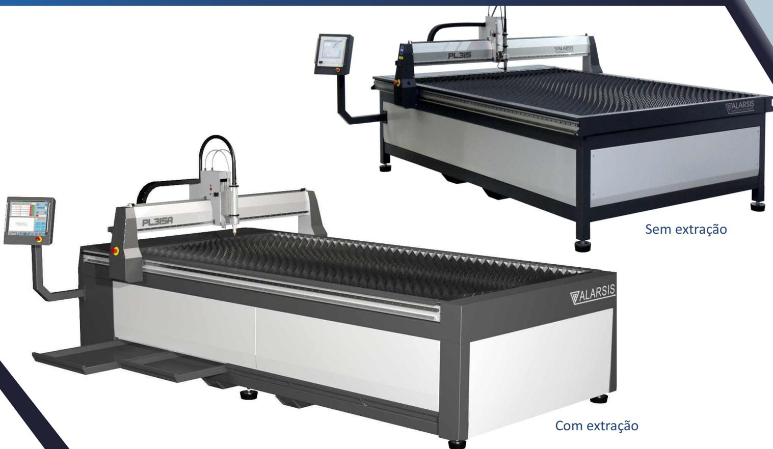
Novos modelos de alta produção para o corte de aços de plasma. Disponível em dois tamanhos padrão e também feito sob medida, com a possibilidade de uma mesa de grade simples com extração de fumos setorizada ou lagoa de água. Os modelos PL210 e PL315 têm com controle de altura próprio (THC) e podem incorporar qualquer marca de Plasmas como Hypertherm, Tecnomec, etc.
