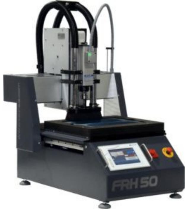
Modelo de pequeno formato para produção de fresagem, onde um elevado nível de potência e precisão é necessário. É a máquina indicada para gravações, fresagem de moldes e protótipos. Opção de mesa de vácuo para por exemplo produção de peças ortopédicas. Robustez e baixa manutenção são as características de toda a série FRH. Transmissão por fusos sem-fim em todos os eixos com o exclusivo sistema de porca de esferas rotativas.
