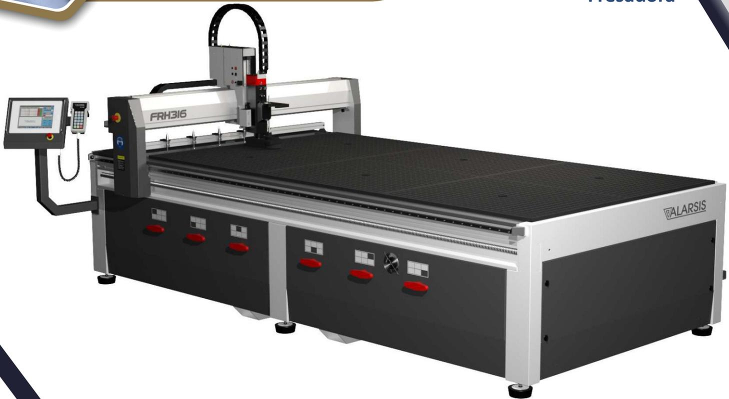
Modelo de grande formato para alta produção de fresagem, onde um elevado nível de potência e precisão é necessário. Robustez e baixa manutenção são as características de toda a série FRH. Transmissão por fusos sem-fim em todos os eixos com o exclusivo sistema de porcas esferas rotativas. ATC - Troca automática de ferramentas como opção. Bomba de vácuo no interior da máquina
